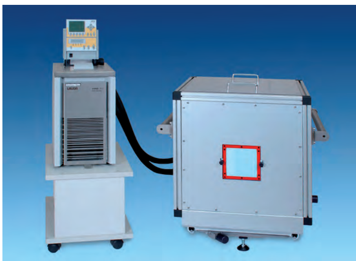
Abbildung 3: Das sogenannte „transportable“ Wasserkalorimeter mit zugehörigem Kühlaggregat. Die Temperaturstabilisierung dieses Kalorimeters geschieht mit Hilfe aktiv gekühlter Platten, die das gesamte Wasserphantom bis auf den Bereich des Strahlungseintrittsfensters (rot umrandet) umgeben. Die Kantenlänge des Kalorimeters beträgt ca. 60 cm. Die Dicke der Dämmschicht aus Polystyrol beträgt im Bereich des Strahlungseintrittsfensters ca. 18 cm.
