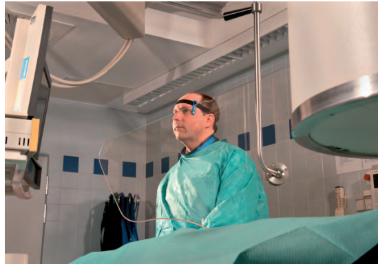
Bild 2: Angiographie. Das Augen-Personendosimeter wird an der linken Kopfseite in Richtung zum Patienten getragen.
