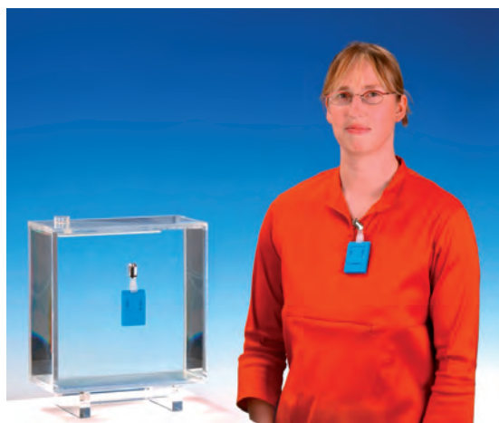
Bild 1: Ein Personendosimeter, hier das Gleitschattenfilm dosimeter, misst nur beim Tragen am Rumpf der Person richtig. Daher muss das Dosimeter beim Kalibrieren auf einem den Menschen ersetzenden Phantom platziert werden.
