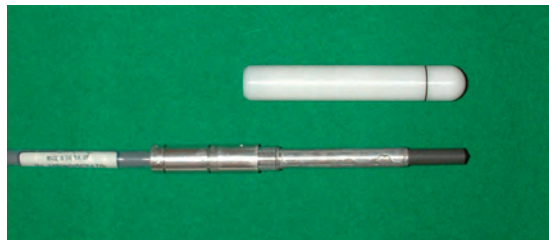
Abbildung 1: Eine typische, für Dosismessungen in der externen Strahlentherapie verwendete Ionisationskammer (unten) mit Schutzhülse (oben). Der luftgefüllte Hohlraum befindet sich im Inneren des auf der rechten Seite erkennbaren schwarzen Graphit-Zylinders, der einen Durchmesser von 7 mm und eine Länge von 24 mm hat. Die Wand dieses Graphit-Hohlzylinders hat eine Dicke von nur 0,36 mm und dient als eine der beiden Elektroden zur Erzeugung des elektrischen Feldes. Die zweite Elektrode befindet sich im Inneren des Luft-Hohlraumes und ist von außen nicht sichtbar.
