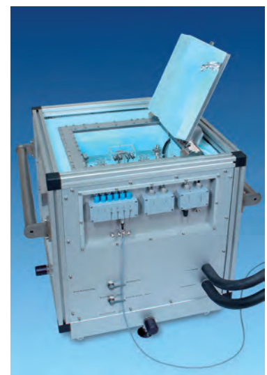
Abbildung 3a: Foto des transportablen Kalorimeters von der Rückseite mit geöffnetem Deckel des Kühlgehäuses.
